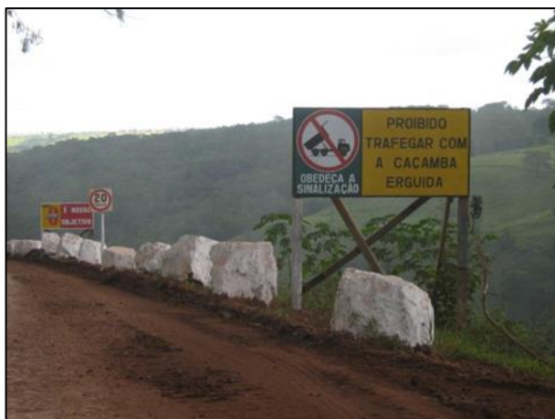
Figura 4 – Exemplo de “sinalização de proibição de tráfego com caçamba erguida”.
